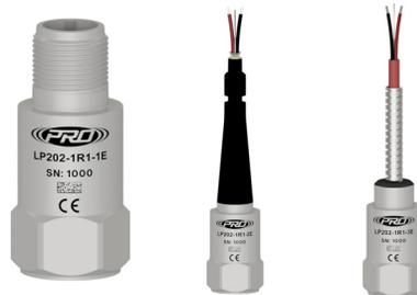
Solo se requieren dos cables para suministrar energía al sensor y enviar la señal actual. Se utiliza un voltaje de alimentación de bucle para alimentar el sensor remoto. Una resistencia en serie  $R_L$  en la fuente de alimentación de bucle convierte esta corriente en un voltaje que puede ser utilizado por el monitor-controlador de proceso para registrar o distribuir el parámetro que se está midiendo.
