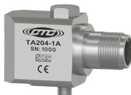
TA204 100 mV/g, 10 mV/°C, tolerancia de sensibilidad de \pm 10\% , -40 to 121 °C (-40 to 250 °F)
