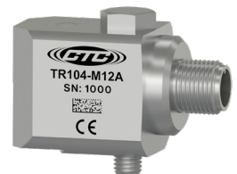
TR104-M12A 100 mV/g, tolerancia de sensibilidad de \pm 10\% , PT100 RTD, -40 to 121 °C (-40 to 250 °F)
