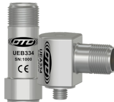
UEB334 y UEA334 Bajo costo, 100 mV/g, \pm 15\% , pico resonante: 42 kHz \pm 2 kHz
