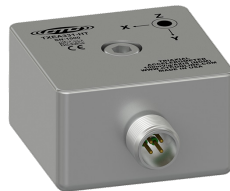
TXEA331-HT 100 mV/g, tolerancia de sensibilidad de \pm 5\% , temperatura máxima: 162 °C (325 °F)
